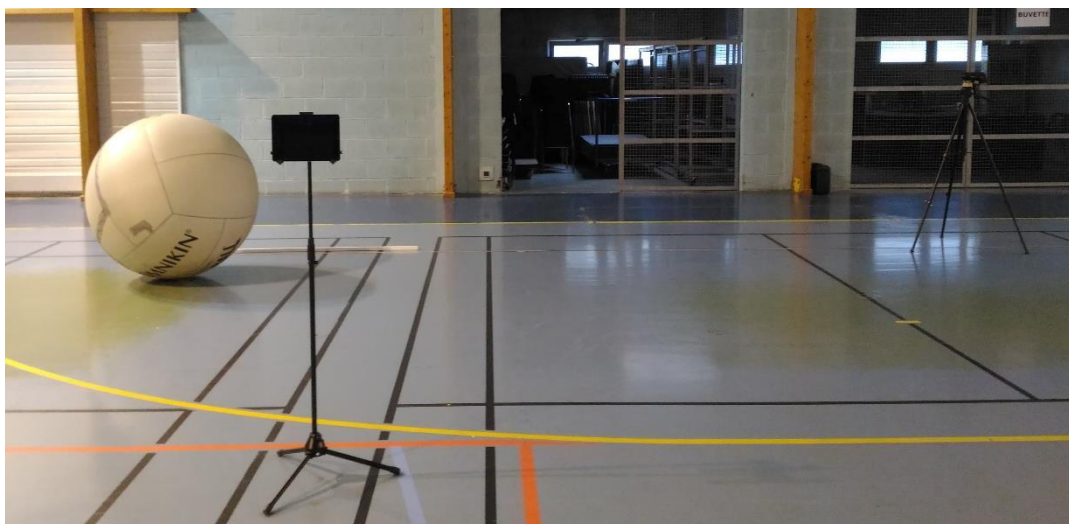
Figure 5 : Installation pour la prise des mesures de la vitesse de ballon
