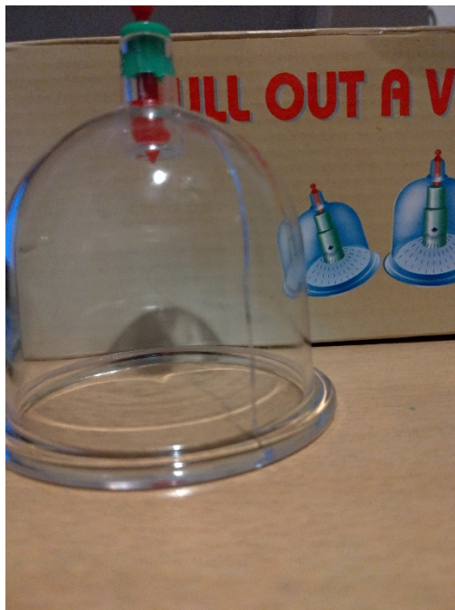
Figure 12 - Ventouse présentant une fissure laissant l'air s'échapper empêchant ainsi la pression négative
